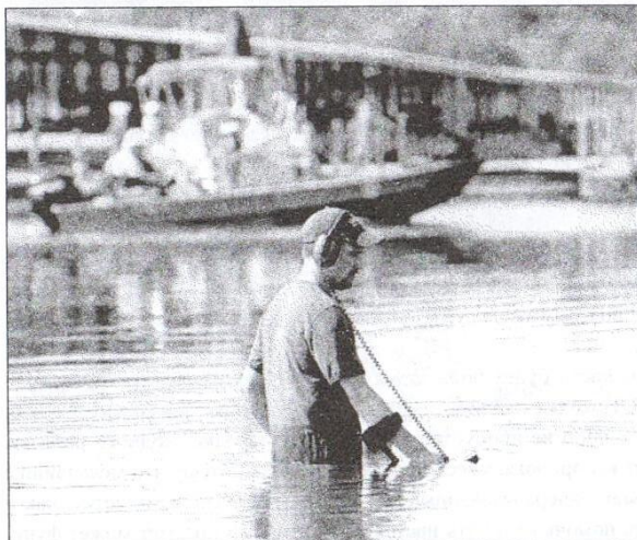
Стандартные наушники, поставляемые с AT Gold , оборудованы водозащищённым разъёмом. Если они целиком должны быть погружены в воду, необходимо использовать специальные наушники (продаются отдельно).
